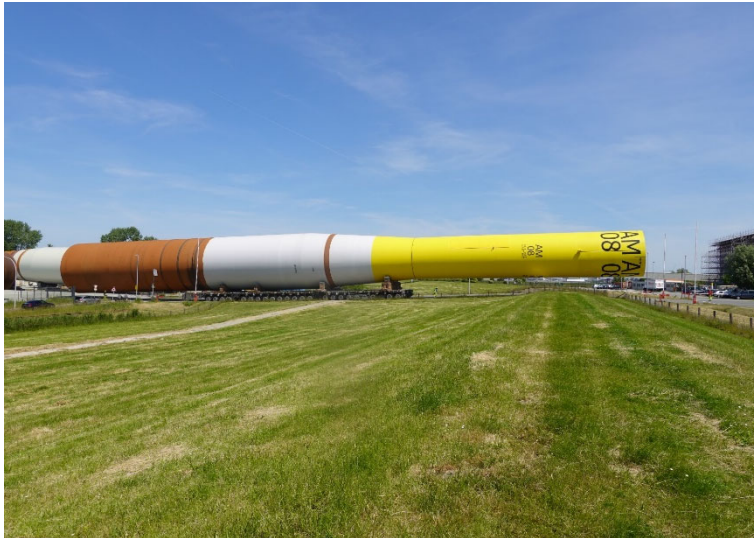
Bild 5: Transport eines Monopiles auf SPMT
