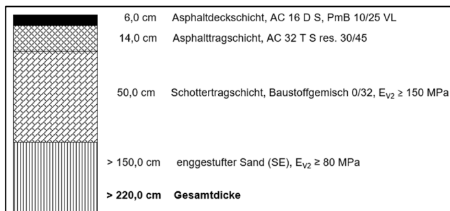
Bild 7: Aufbau der Verkehrsflächenbefestigung für die Deichquerung
