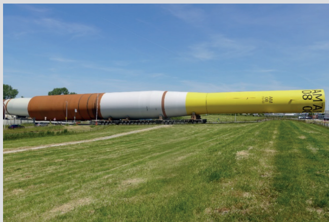
Bild 8: Transport eines Monopiles auf SPMT
