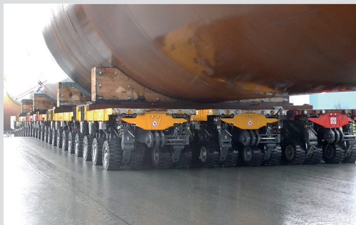
Bild 9: Transport eines Monopiles mittels SPMT über eine Deichquerung
