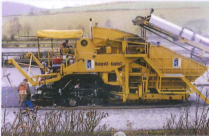
Bild 2: Erstmaler Einbau einer Kompakten Asphaltbefestigung mit dem Kompaktmodulfertiger, BAB A 7 „Reckeröder Berg“, untere Schicht 9,5 cm ABi 0/22 S mit Straßenbaubitumen B 65 und 1,2 % Naturasphalt und obere Schicht 2,5 cm SMA 0/8 S mit Polymermodifiziertem Bitumen PmB 45 A (Bild: Kirchner Holding GmbH)
