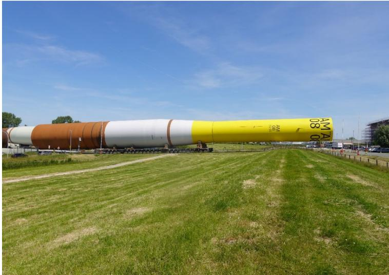
**Bild 5: Transport eines Monopiles auf SPMT**
