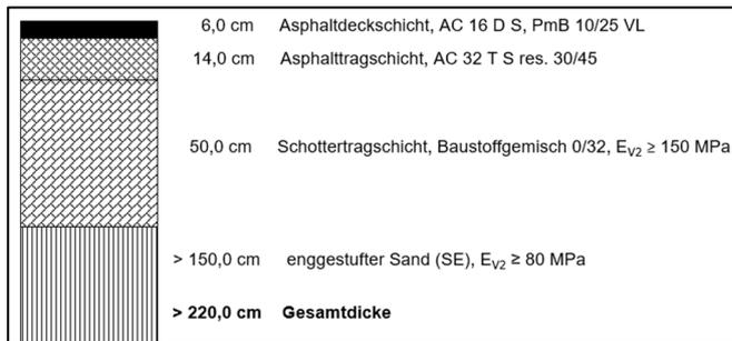
**Bild 7: Aufbau der Verkehrsflächenbefestigung für die Deichquerung**
